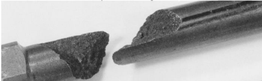
Figura 17-Superfície de fractura do ferro fundido cinzento.
