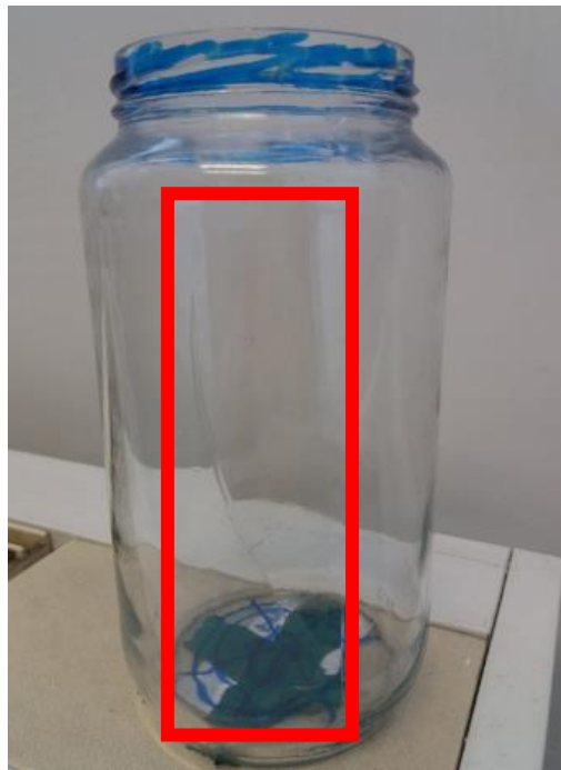
Figura 11- Frasco de vidro de boca larga assinalado a vermelho o defeito gelha
