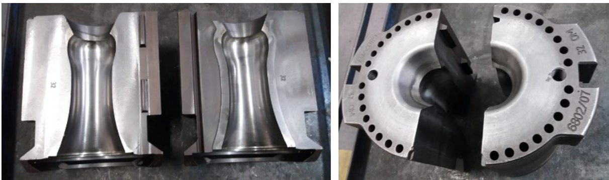
Figura 12-Contramoldes em ferro fundido, artigo 6802
