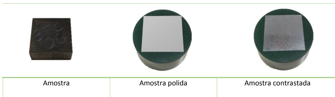
Figura 30-Etapas de preparação das amostras
